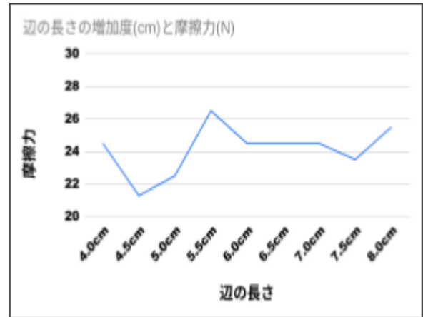
図3: 底面積の推移と摩擦力の変化
