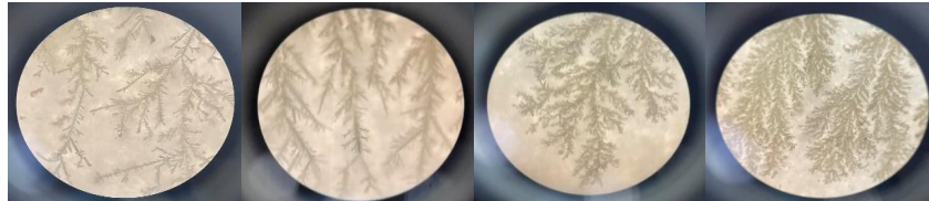
0mA 2mA 3mA 5mA 写真3 銀樹の細部の形状の変化(光学顕微鏡100倍の写真)
