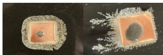
無電流時 放電時 写真6 銀樹の形成の仕方の違い
