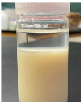
(図2)実験Ⅱ：分離後のリン酸鉄Ⅲ塩の様子
