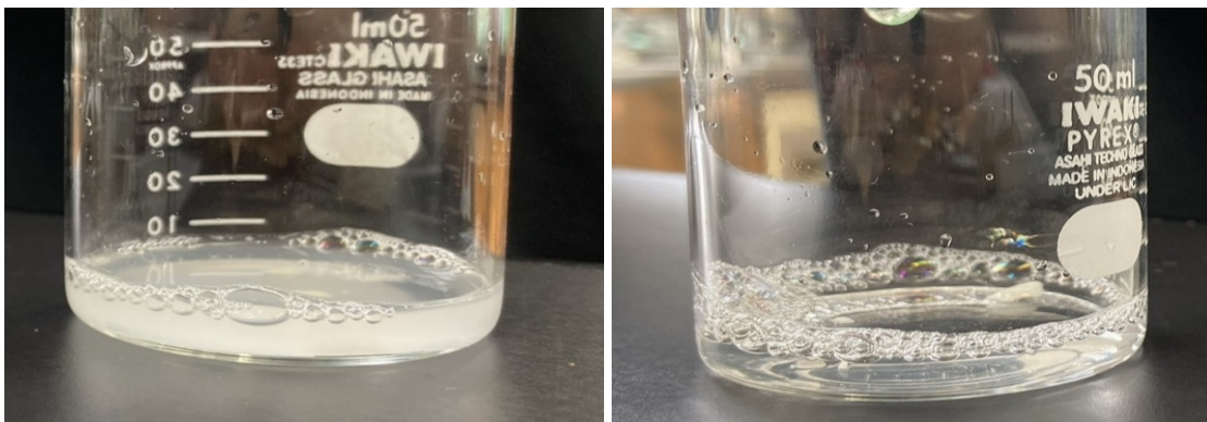
非オゾンセッケンを水に溶かした様子 オゾンセッケンを水に溶かした様子
