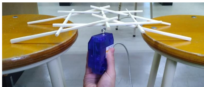
図1 橋に電子天秤をかけ、力をかけている様子
