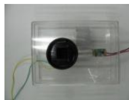
図3 レーザー式（黒い部分がセルケース、センサーおよびフィルターはケース内）
